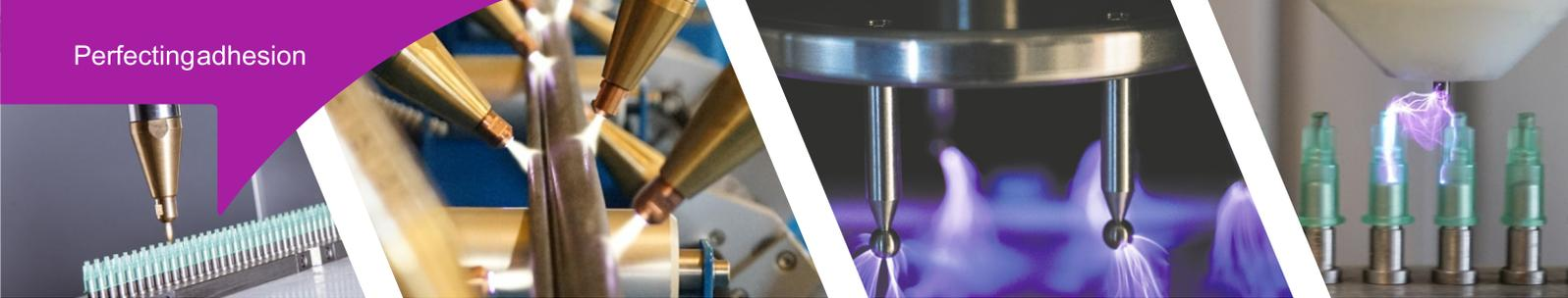
VacuTEC-Systeme arbeiten mit sehr kurzen Behandlungszeiten und verbessern die Adhäsion für Lacke, Beschichtungen, Druckfarben, Tinten und Klebstoffe. In der Behandlungskammer wird ein Vakuum von 0,5 bis 6 mbar erzeugt, dann erfolgt eine Hochspannungsentladung durch die integrierten Plasmaelektroden.
