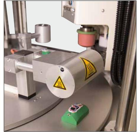
Komponente Infrarottrocknung – verkürzt die Trockenzeit der Tampondruckfarbe
