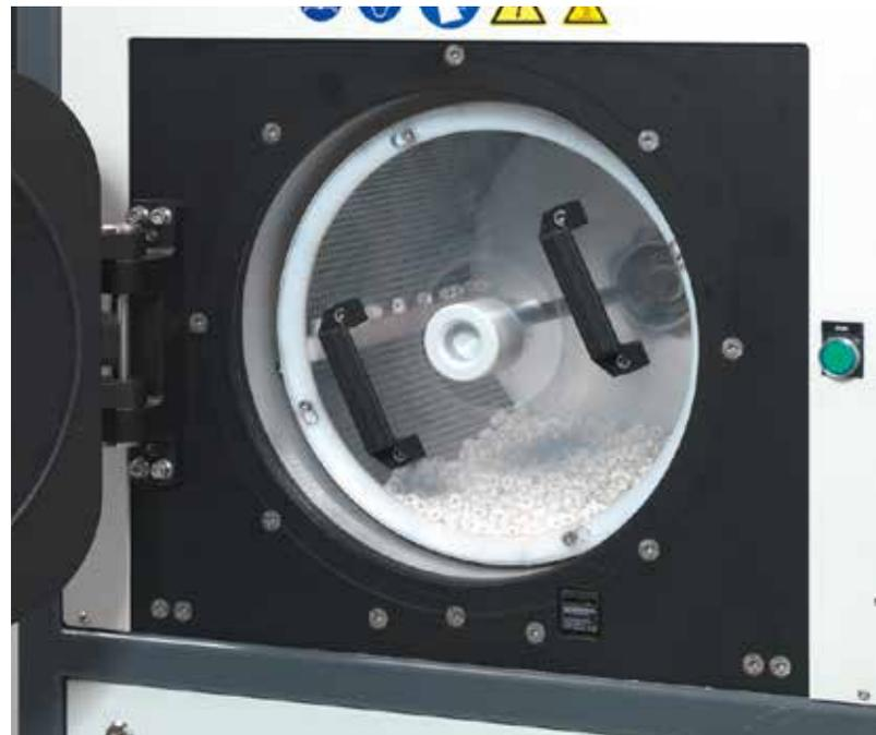
**RotoVAC Anlagen von Tantec sind speziell für die Vorbehandlung von kleinen, komplex geformten Spritzgußteilen konstruiert. Die rotierende Vakuumkammer macht komplizierte Handlingsystem überflüssig. Das Behandlungsgut wird einfach in die Trommel gegeben und diese in die Vakuumkammer eingesetzt. Durch die Rotation der Trommel werden garantiert alle Teile behandelt.**
