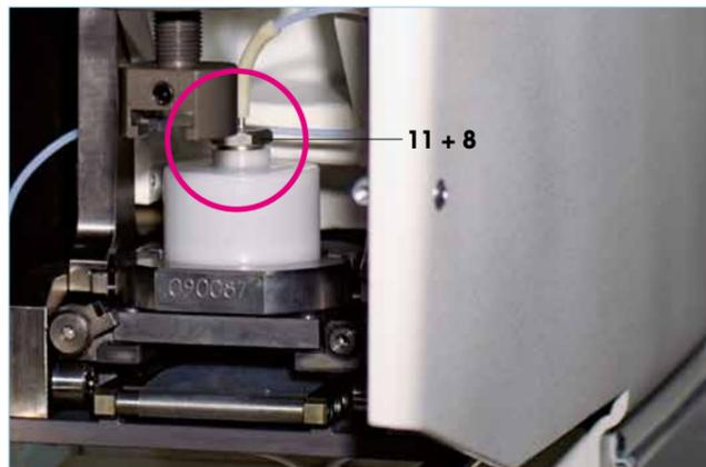
Abb.: Befestigung von Ablaufschlauch (8) mittels Verschlussstopfen (11) an Farb-/Raketopf (12)
