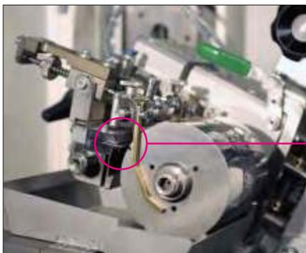
Abb.: "Stahl-Klischeewalze" eingebaut im Rotations-Tampondruckwerk
