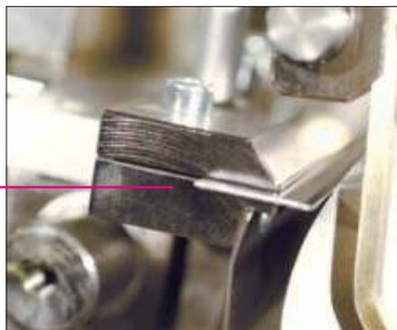
Abb.: Rotationsdruckrakelmesser im Rotations-Tampondruckwerk
