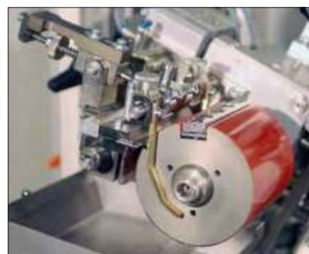
Abb.: Spannwalze montiert im Rotations-Tampondruckwerk
