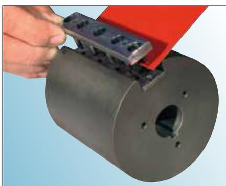
Abb.: Magnet-Raster-Spannklischee "R" vor dem Biegen
