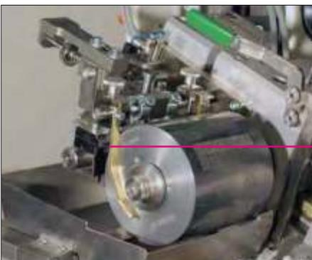
Abb.: "Hightech-Keramik-Klischeewalze" eingebaut im Rotations-Tampondruckwerk
