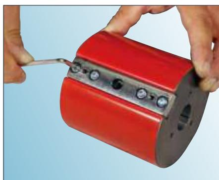
Abb.: Magnet-Raster-Spannklischees "R" ist auf Spannwalze aufgezogen
