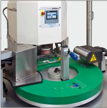
Multifunktions-Werkstückaufnahme umringt von Tampondruckmaschine und Komponenten (Abb.: Corona-Vorbehandlung, Teileerkennung, Infrarot-Trocknung)
