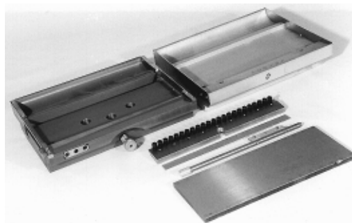
von oben nach unten: links Klischeehalter, rechts Farbbecken, Rakelhalter, Farbspachtel, Farbspachtelhalter
