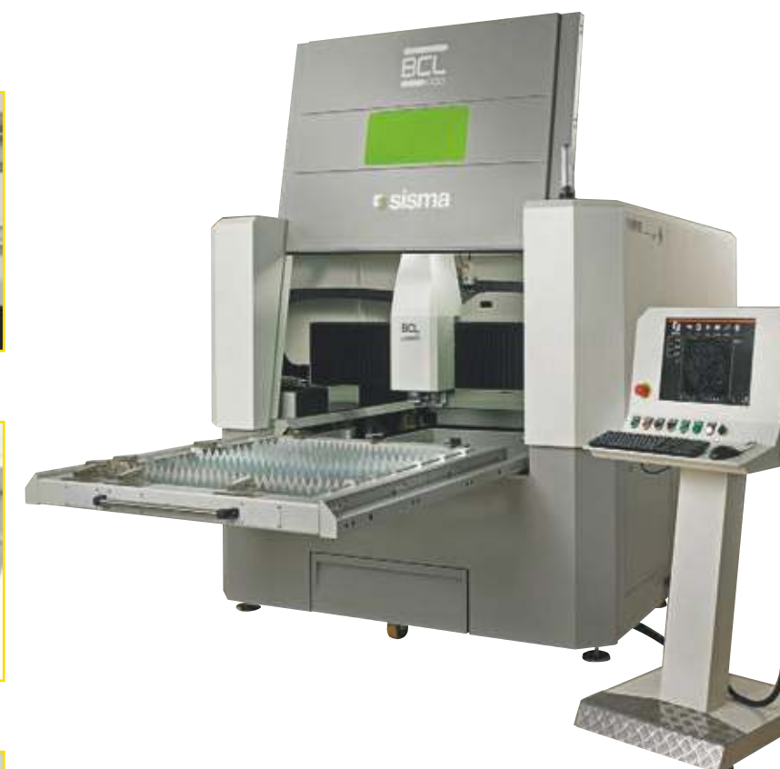
Pneumatische Spannvorrichtung für mittelgrosse Platten
