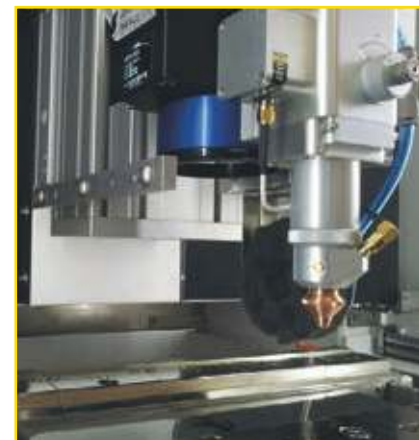
Kombinierte Laserschneid und Markierfunktion
