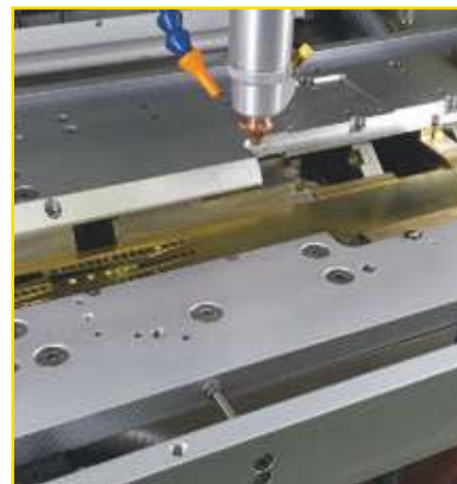
Anschlagplatte auch pneumatisch mit einstellbarem Hub erhältlich
