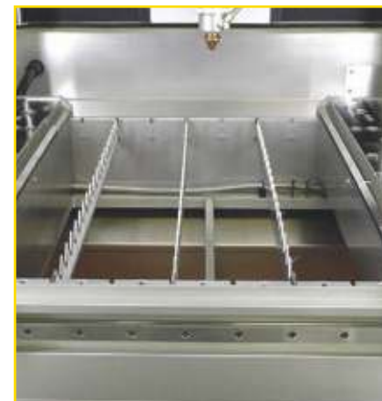
Frontladeschneidkasten mit Nagelbett. Pneumatische und manuelle Anschlag- und Spannvorrichtungen
