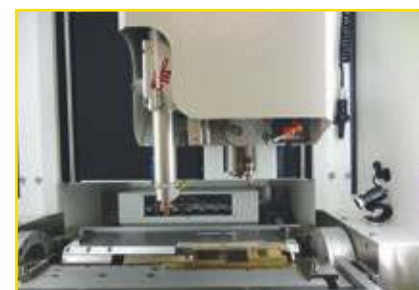
Absaugsystem im Bearbeitungsbereich
