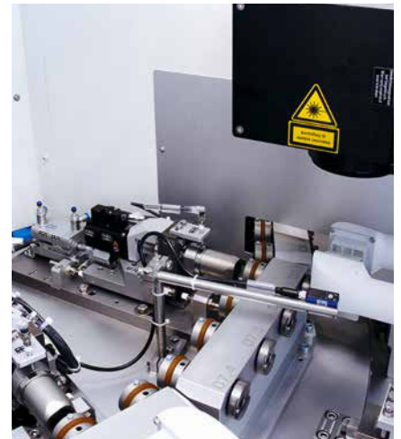
Die Markierung im EDM-Verfahren findet während einer kontinuierlichen Drehung des Bauteils statt
