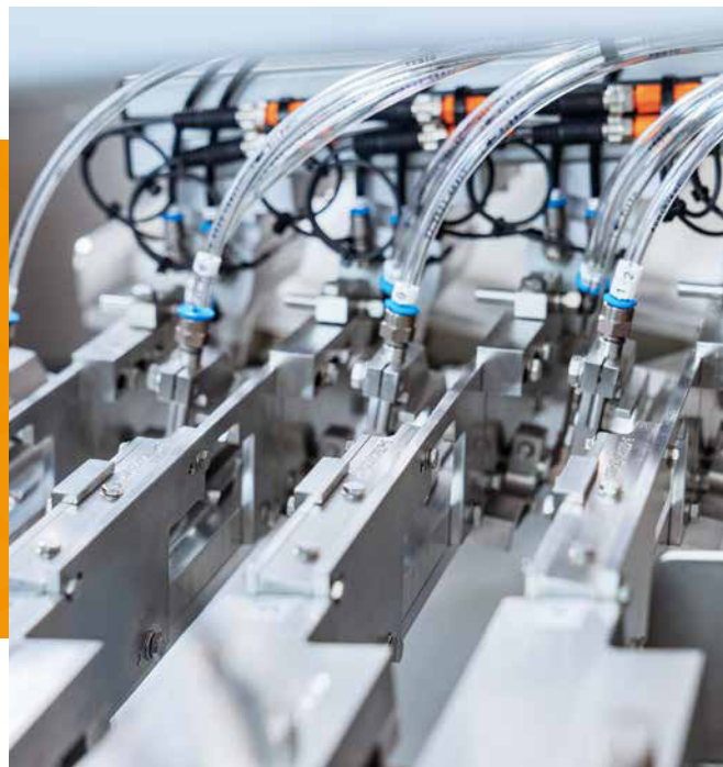
Zuführsystem Mehrspurig lineare Zuführsysteme ermöglichen eine hohe Produktionsausgabe der gekennzeichneten Bauteile
