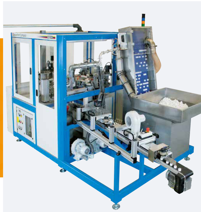
CLOSURE PRINT COMPACT Kompakte Vollautomation zur Bedruckung kleiner Ausbringungsmengen von Verschlusskappen
